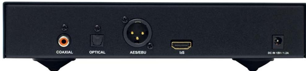
Gleich viermal steht das Digitalsignal zur Abholung bereit, darunter per I²S, der klanglich besten Verbindung, die aber nicht jeder DAC bietet.
