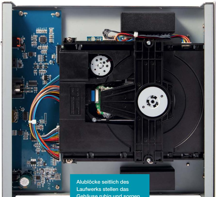
Alublöcke seitlich des Laufwerks stellen das Gehäuse ruhig und sorgen für mehr Gewicht. Immer gut bei bewegten Teilen.
